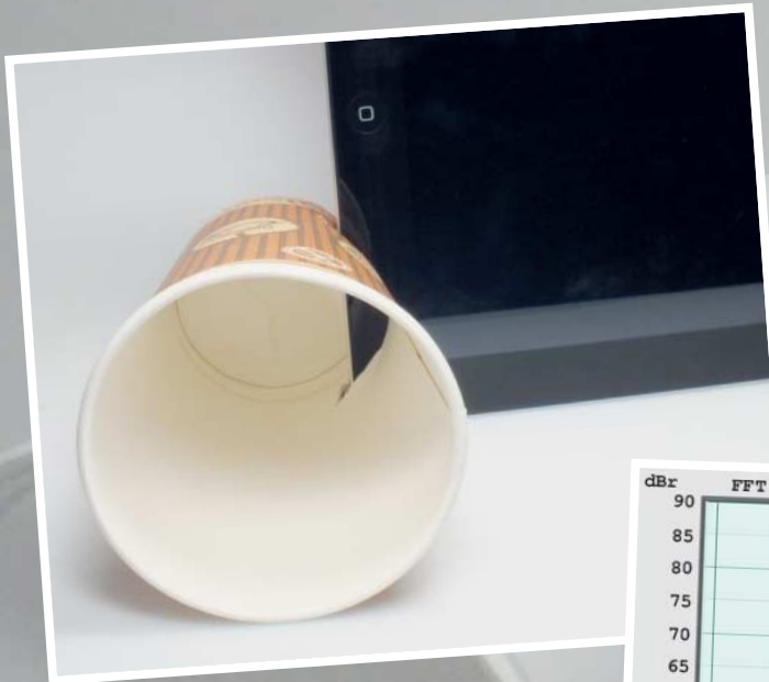
Aufgeschlitzt und aufgesteckt: Der Kaffeebecher verbessert den Klang eines iPad sofort.
