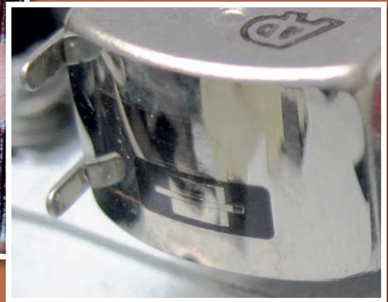
Der Luftspalt eines Schreib-Lesekopfs eines Stereo-Kassettenrekorders zum Beschreiben eines Magnetbandes ist nur wenige \mu\text{m} breit.
