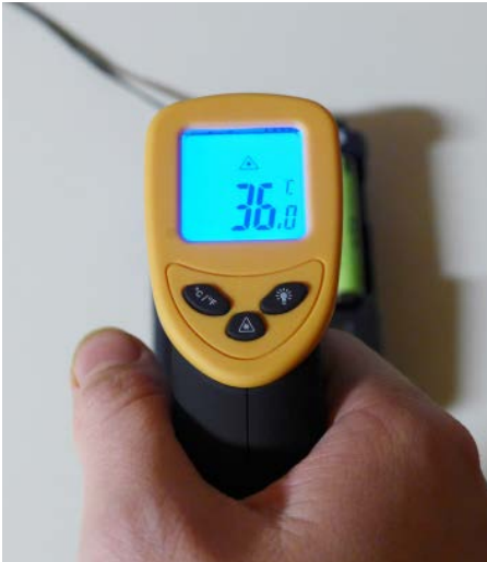
Überprüfen der Ladetemperatur
