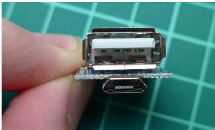
Das Step-Up-Modul 134N3P bietet USB-Anschlüsse zum Laden und Entladen.
