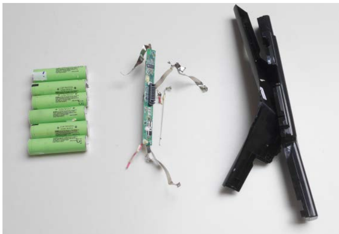
Die ausgebauten Zellen, Ladeelektronik und Plastikgehäuse
