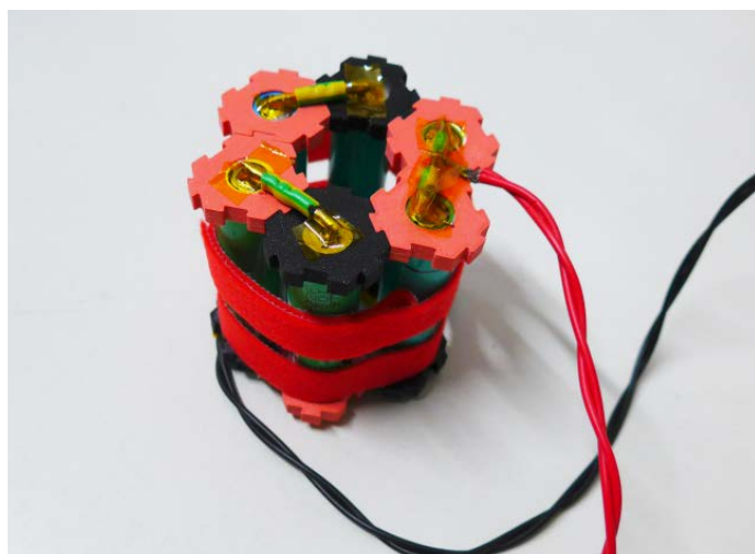
3S2P-Akku mit selbstgedruckter Halterung
