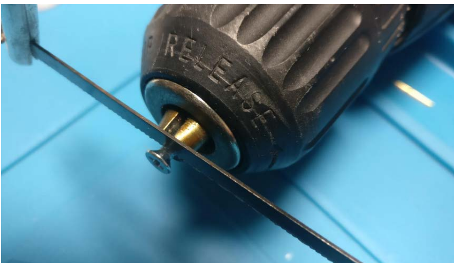
Die Schraube im Akkuschauber festklemmen und den Schraubenkopf abtrennen.
