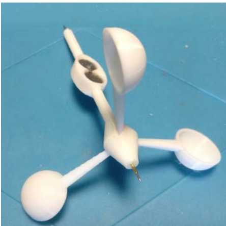
Das Flügelschalenanemometer fertig montiert.
