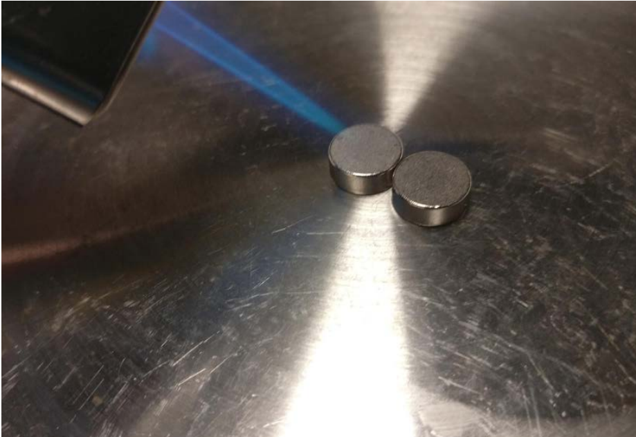
Die Neodyme durch kurzes Erhitzen etwas entmagnetisieren.
