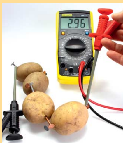
Parallelschaltung: Vier Kartoffeln erzeugen knapp drei Volt.
