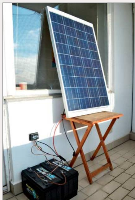
Energieernte mit Solarpanel, Laderegler und zwei Batterien
