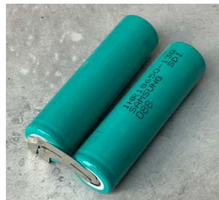
7 Ausgebautes Batterie-Paar eines Alt-Akku. Vor dem Entsorgen die Enden mit Isolierband abkleben!
