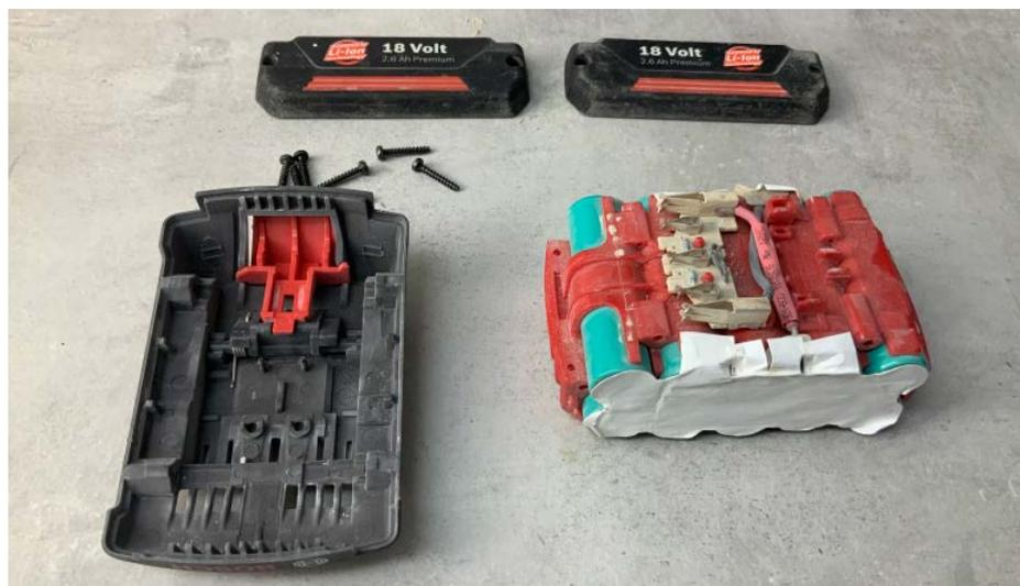
5 Zerlegter Bosch-18V-Akku: Die einfache Ladeelektronik balanciert die Zellen nicht aus. Ein Kandidat für ein Upgrade.
