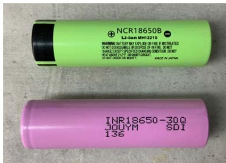
2 Weitverbreitete Akkuzellen vom Typ 18650: Die Buchstaben oder Zahlen hinter der Typenbezeichnung stehen für herstellerspezifische Varianten.
