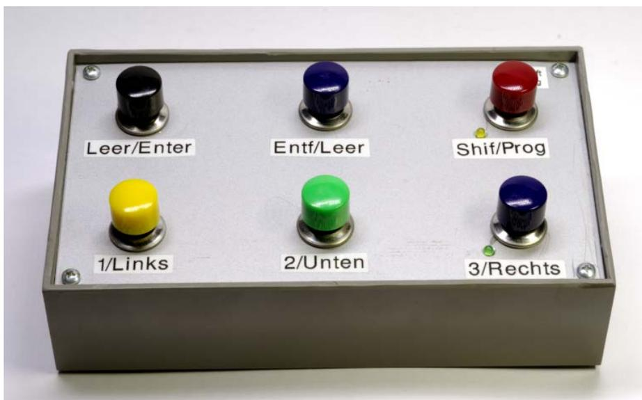
12 Zusatztastatur in Fertiggehäuse aus dem Elektronikbedarf
