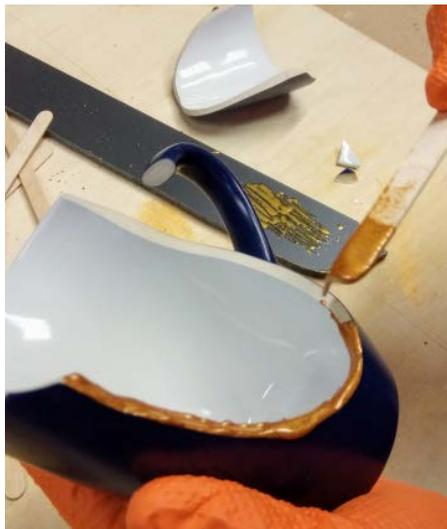
Klebmasse auf die Bruchstelle auftragen.
