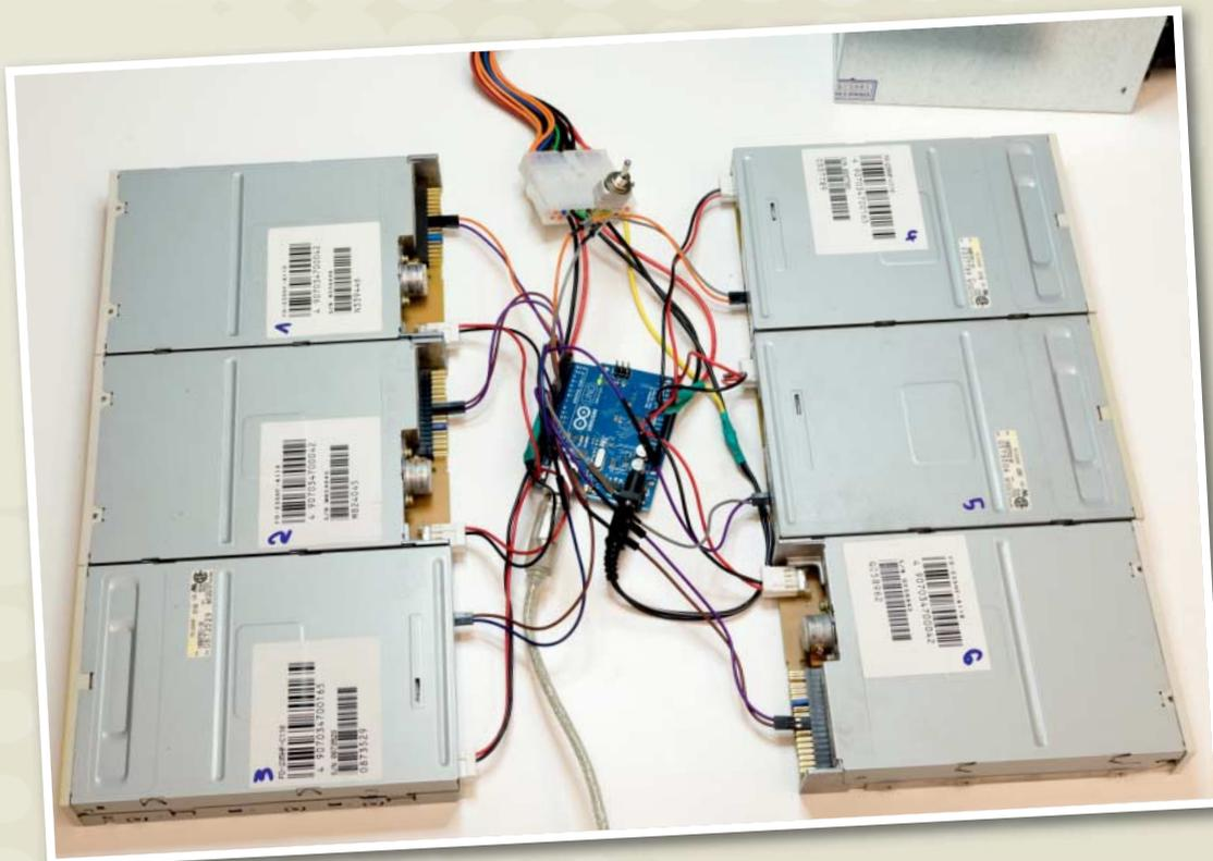
So sieht unser Eigenbau mit sechs Laufwerken aus. Wichtig für den Sound: Eine harte Unterlage wie ein Tisch oder ein Brett, das die Vibrationen verstärkt.
